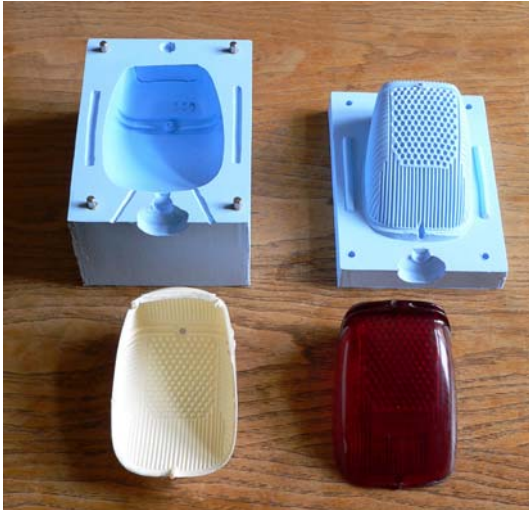
forma na koncové světlo mopedu Stadion S23 (vyrobena ze série MM900)
